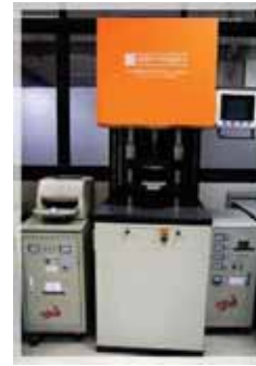
เครื่องที่ใช้ทดสอบสมบัติการไหล และค่าความหนืดของยางและพลาสติก
